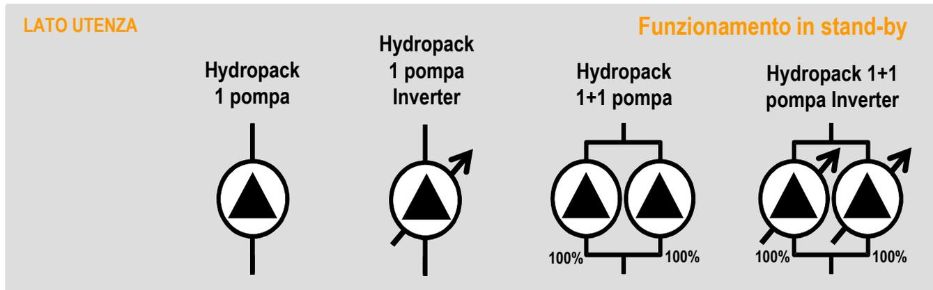
Con la **pompa inverter** l'unità può gestire **portate d'acqua variabili**
